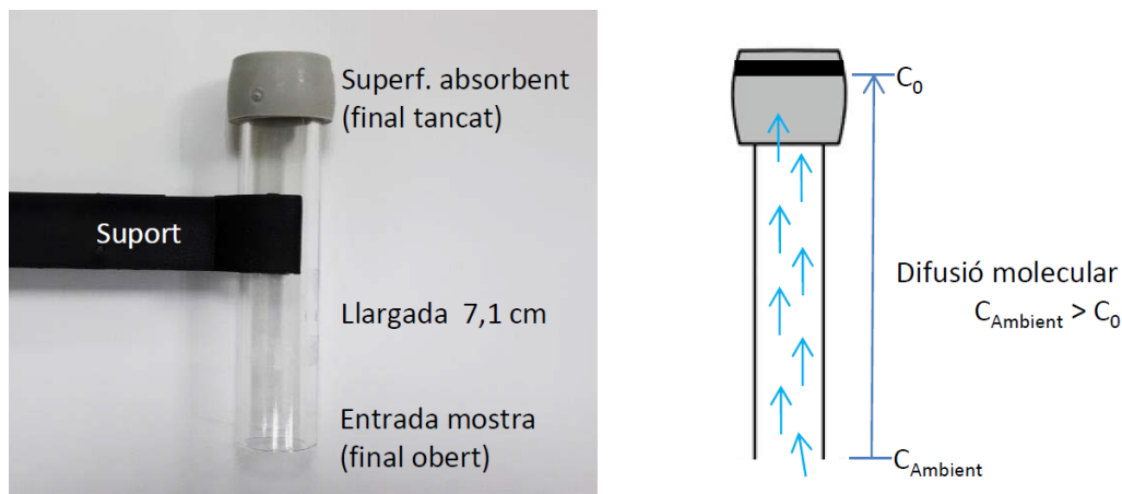
Figura 1: Principi de funcionament dels tub passius de difusió de NO 2 de tipus Palmes, on C_{\text{Ambient}} és la concentració de la mostra ambiental i C_0 és la concentració a la superfície de l'absorbent.
