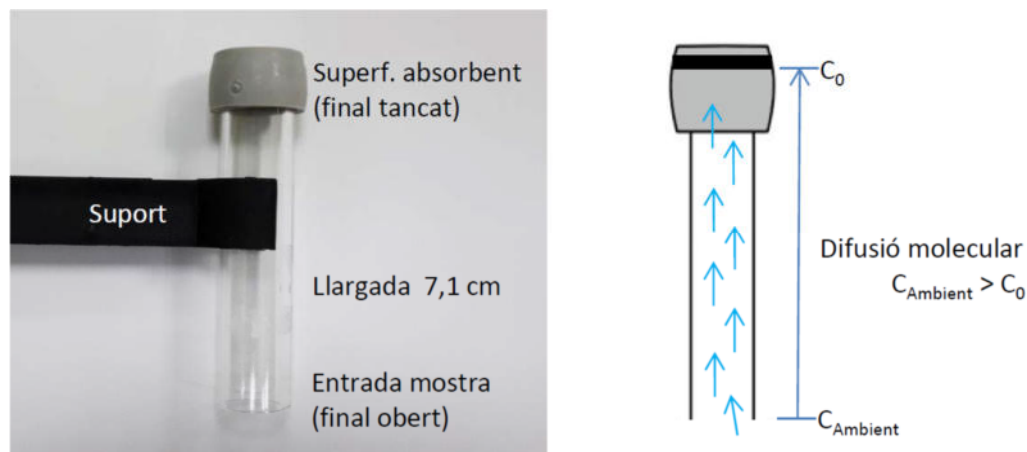
Figura 1: Principi de funcionament dels tubs passius de difusió de NO 2 de tipus Palmes, on C_{Ambient} és la concentració de la mostra ambiental i C_0 és la concentració a la superfície de l'absorbent.
