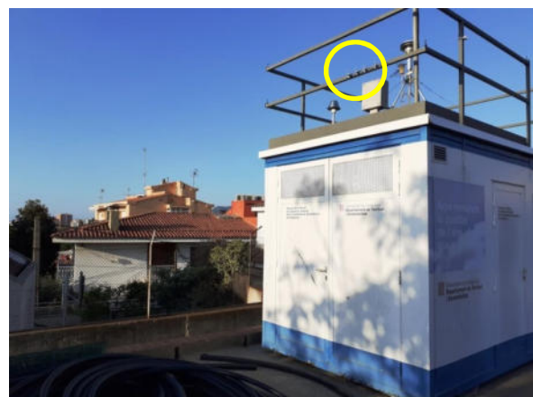
Figura 4: Plànol de situació de l'Estació de la XVPCA situada al pg. dels Molins (cercle groc) i imatge dels tubs de control.
