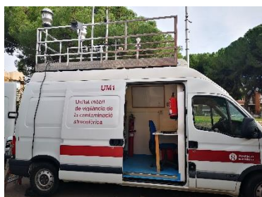
Fotografies: Instal·lació dels sensors en la UM1 en l'estudi de correlació de dades a Cerdanyola del Vallès
