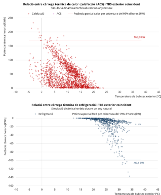
Fig. 13 Distribució horària de les demandes i càrregues en funció de la temperatura exterior (Cas núm. 1) Font: SUNO
