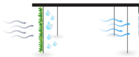
Esquema 3. Ventilació natural i vegetació als umbracles
