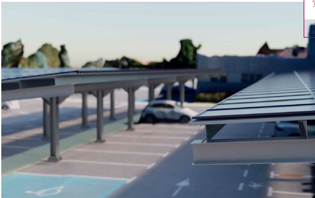
Imatge 15. Simulació pèrgola fotovoltaica en l'aparcament
