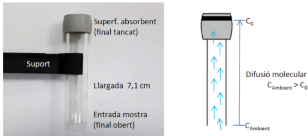
Figura 1: Principi de funcionament dels tubs passius de difusió de \text{NO}_2 de tipus Palmes, on C_{\text{Ambient}} és la concentració de la mostra ambient i C_0 és la concentració a la superfície de l'absorbent.
