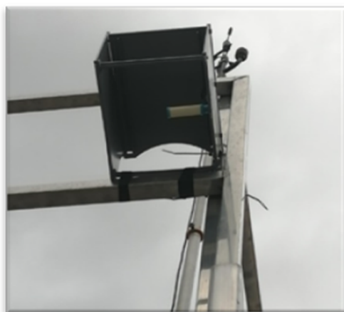
Figura 10. Captador passiu instal·lat a la Unitat Mòbil
