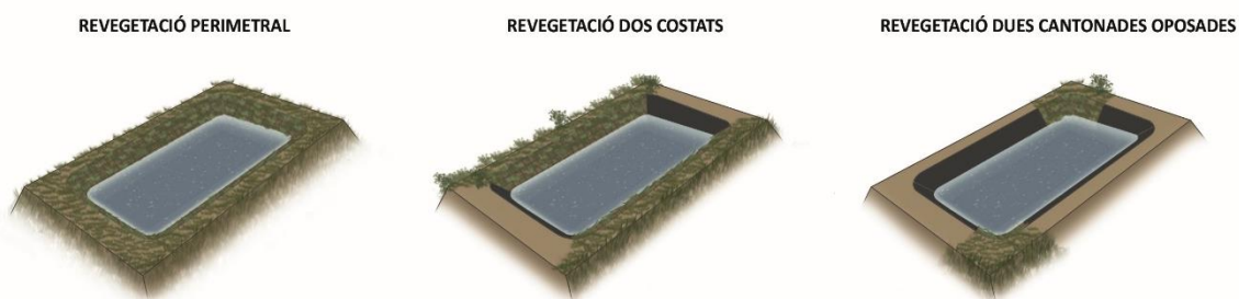
Figura 9. La revegetació dels marges es pot aplicar en tot el perímetre de la bassa o, en cas que no sigui possible, en dos dels laterals o en dues cantonades oposades. Aquesta última alternativa es considera útil solament per a basses inferiors a 20x10 m.
