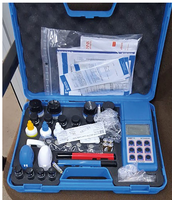
Maletí amb el kit per les mesures dels diferents paràmetres reglamentaris del sistema d'aigua potable de l'Àrea d'esplai i el campament juvenil el Solell del Corredor. Font: Arxiu XPN
