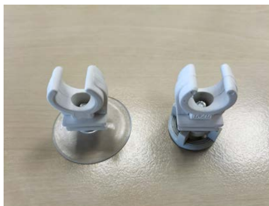
Figura 8. Tipus de suports pels tubs de NO 2 .
