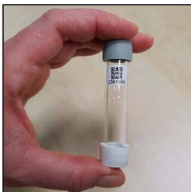
Figura 9. Tub de difusió tipus Palmes amb un codi QR enganxat (amb ambdós taps). Clean Cities. (2024, setembre)
