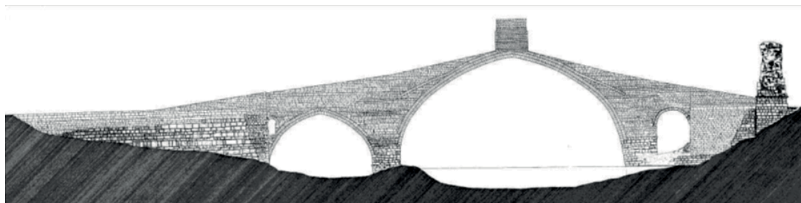
Plànol fotogramètric de l'alçat sud del Pont del Diable, realitzat pel Laboratori de Fotogrametria de la UPC.
