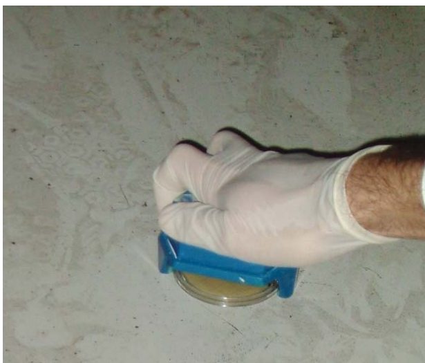
Figura 17. Presa de mostres de superfícies (microbiologia)
