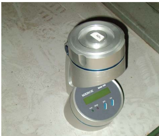
Figura 16. Presa de la qualitat microbiològica de l'aire
