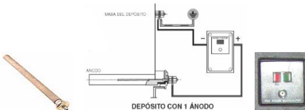
Ànode de magnesi, esquema de connexió i mesurador de càrrega
